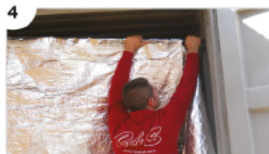
Colocación del tubo telescópico en la parte superior delantera
