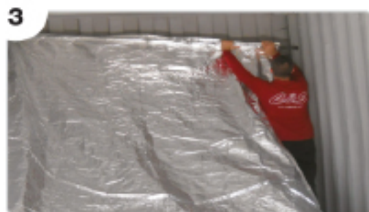
Colocación del tubo telescópico en la parte superior trasera y despliegue
