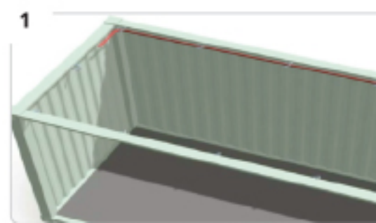
Colocación cinta perimetral en salientes superiores del container
